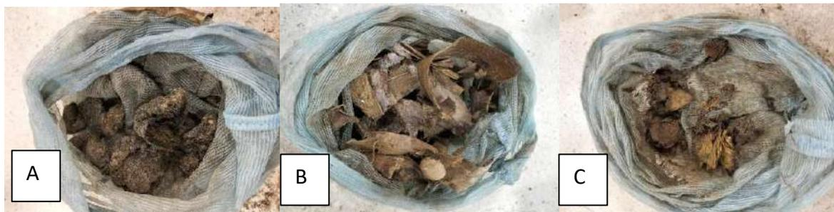
**Figura 4.** Ensayos de degradabilidad en suelo de bioempaques en condiciones amazónicas, luego de tres meses: A. Detalle descomposición del bioempaque semirrígido a partir de calceta de plátano; B. Detalle descomposición del bioempaque semirrígido a partir de hoja de asaí; C. Detalle descomposición bioempaque flexible a partir de almidón de yuca. Fuente: Graison Martínez
