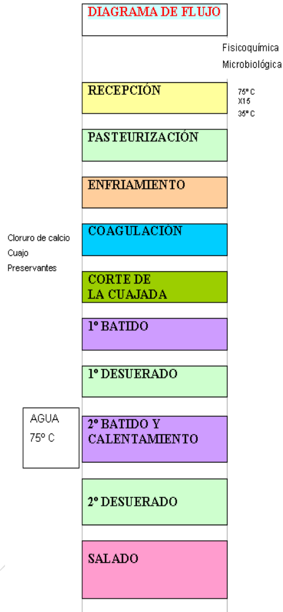
Figura No 4. Diagrama de operaciones para producción de queso
