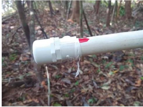
**Figura 36.** Instalación de tapón al final del tubo, cuando no se presenta exudado/extracción de aceite
