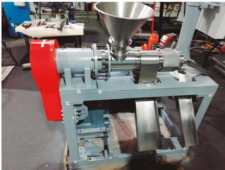
**Figura 19.** Prensa expeller para el prensado y extracción de aceite
