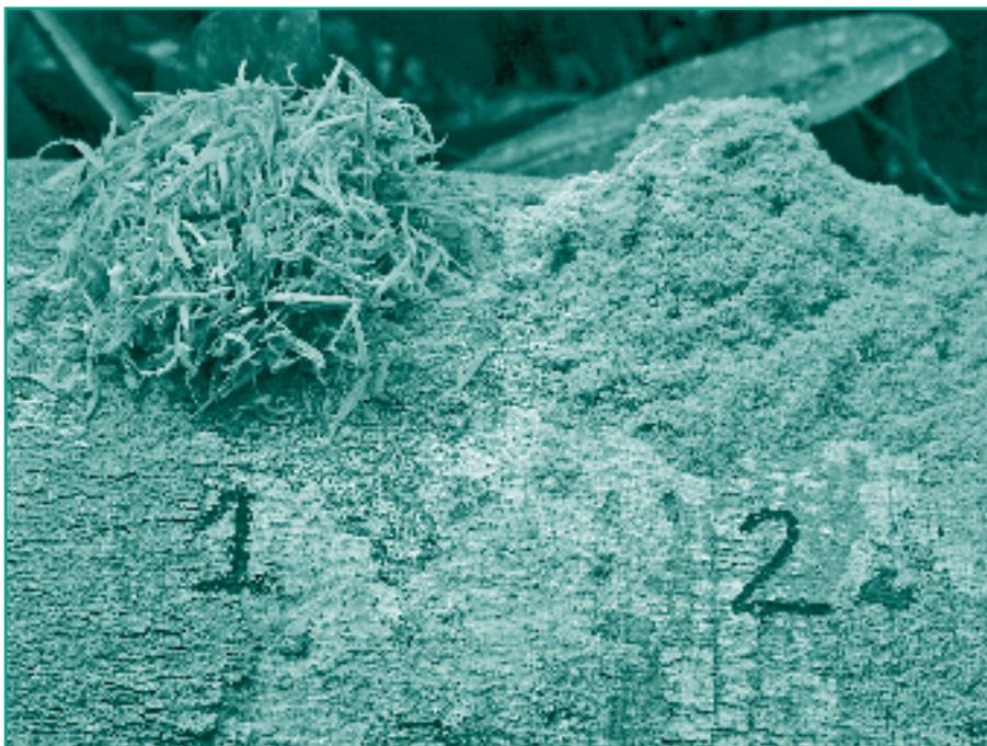
Desperdicios con aserrado a pulso (1) y desperdicios con aserrado con marco (2)
